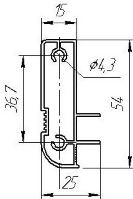
Размеры и присадка отверстий на швеллере 10\*6 полки для дюрок для типовых рамок
